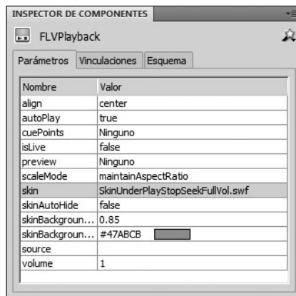
Figura 6. El INSPECTOR DE COMPONENTES nos permite modificar aspectos del componente FLVPlayback como su skin (aspecto), su color , su transparencia o volumen , entre otros.
