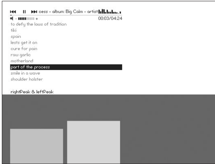
Figura 9. Información visual de los canales de la pista de audio; accedemos por medio de las propiedades rightPeak y leftPeak .
