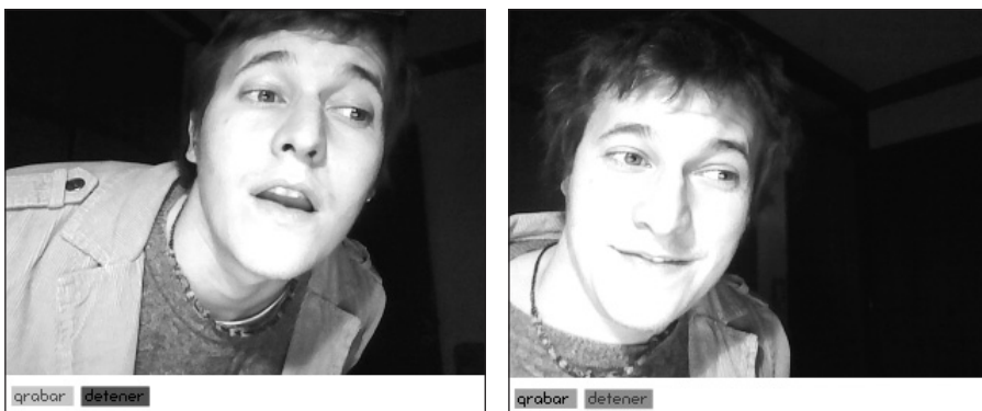
Figura 22. Los dos estados: durante la grabación y una vez que la detenemos. Mientras se graba un video, deshabilitamos el botón de grabar y quitamos su listener. Lo mismo hacemos con el botón de detener una vez que lo presionamos.
