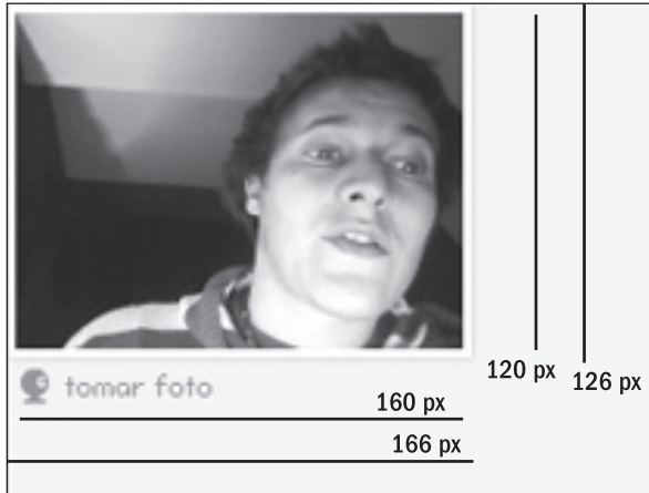
Figura 11. Es importante distinguir entre las dimensiones de la captura de flujo de la cámara web ( 160 x 120 ) y las dimensiones del clip background ( 166 x 126 ).
