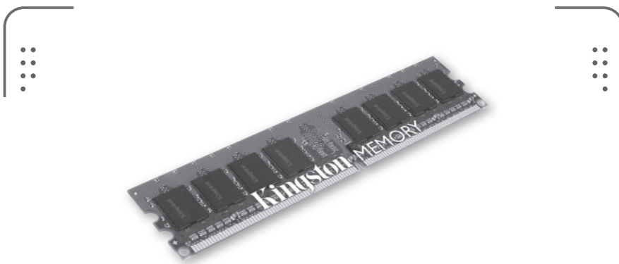
► Figura 12. Memoria DDR2 Kingston. Es muy importante el chip de memoria que este usando, para poder aumentar su frecuencia.
