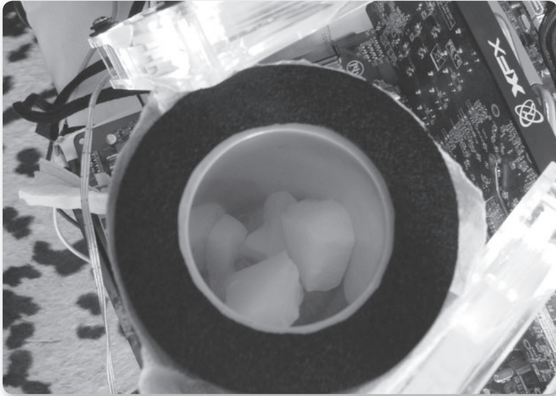
► Figura 6. Un POT de aluminio en plena sección de overclocking. Es común observar hielo en los sectores donde la acetona no llega.
