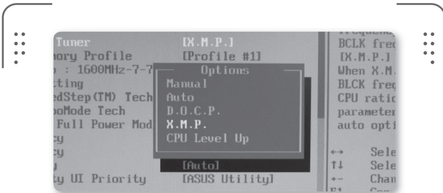
► Figura 17. La posibilidad de carga del perfil XMP, así como un OC del 5% o directamente en forma Manual o automática.
