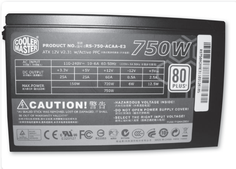
► Figura 17. La etiqueta de una fuente GX 750W de la marca Cooler Master . Esta fuente indica cuántos watts de potencia puede entregar.
