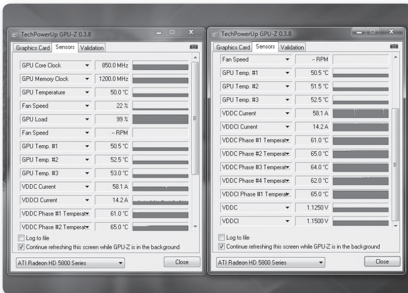
► Figura 12. El consumo medido en GPU-Z de un CrossFire de Radeon 5870 con sus relojes en stock, bajo carga.
