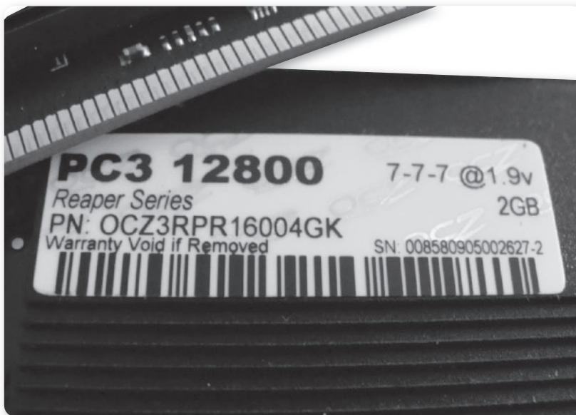
► Figura 14. Módulos de memoria OCZ PC3 12800. Sabemos por el código OCZ3RPR16004GK, que se trata de memorias DDR3 1600 MHz.
