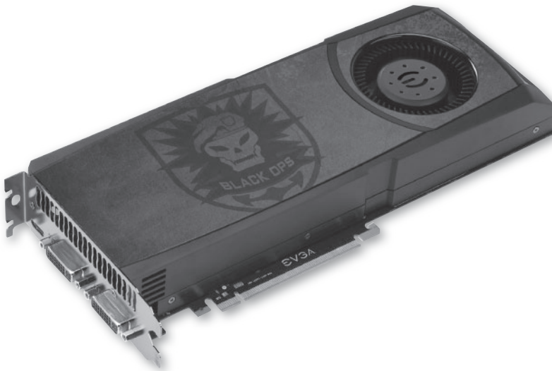
► Figura 9. El sistema de la tarjeta EVGA GTX 580 que vemos aquí, expulsa el aire caliente fuera del gabinete.
