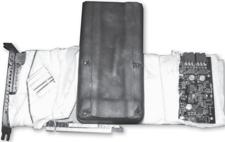
► Figura 12. La aislación continúa con papel absorbente y con Armaflex. El POT tiene que estar completamente aislado con Armaflex.
