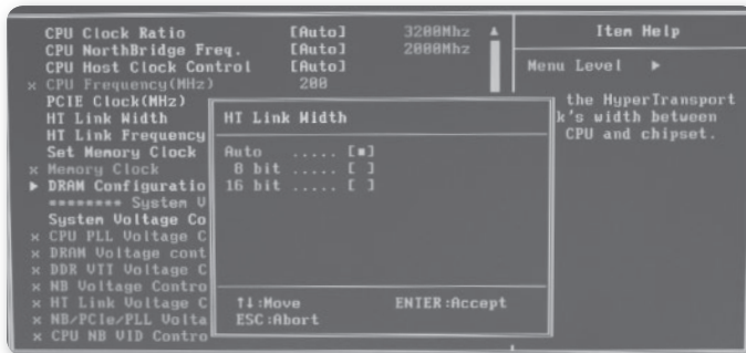
► Figura 5. Es necesario acompañar la capacidad en cuanto al ancho de banda del bus de acuerdo con su velocidad.
