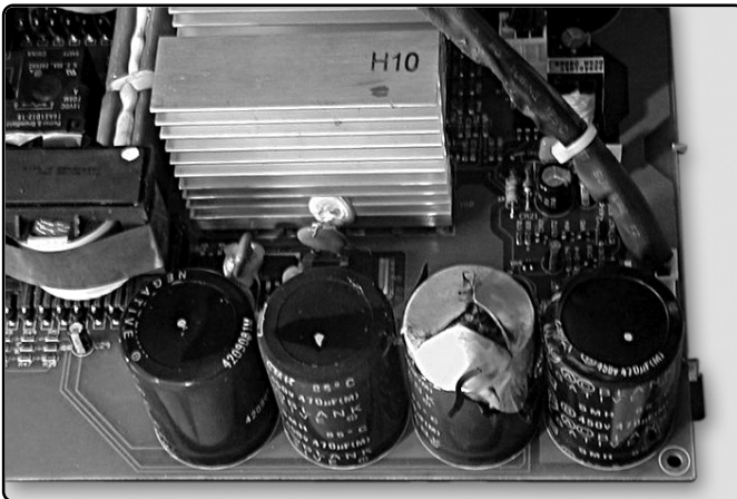
FIGURA 9. Éste es un capacitor explotado; en la mayoría de los casos, es razón suficiente para el reemplazo de la fuente completa.
