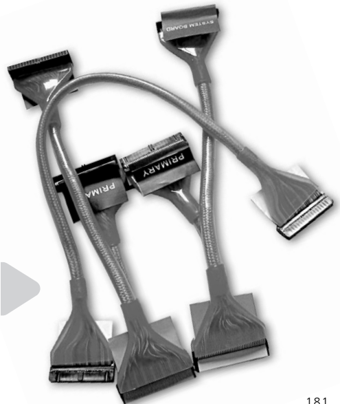
FIGURA 4. Cables IDE y Floppy redondeados de fábrica. Son bastante costosos pero no obstaculizan la circulación del aire de la PC.
