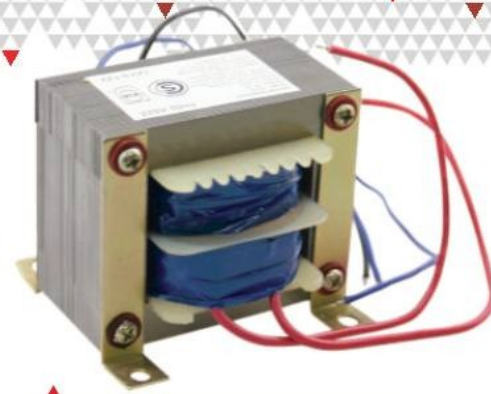
Este es un transformador de 220Vac a 12+12Vac, de 3000mA. Se puede observar el núcleo laminado y los bobinados del primario y secundario.
