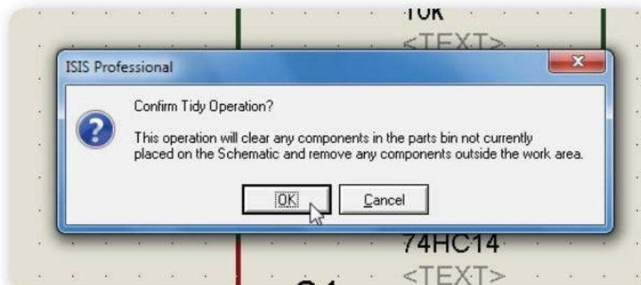
**Figura 11.** **Tidy** permite mantener nuestro diseño limpio y ordenado al eliminar los componentes que no se usan.
