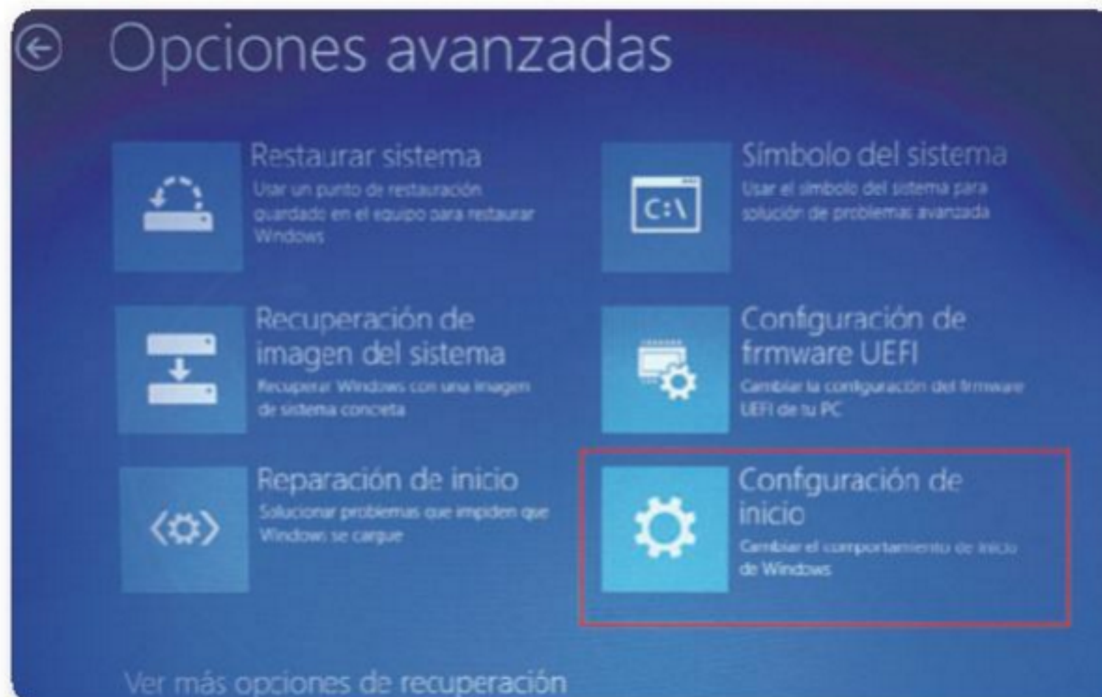
Figura 6. Presionando las teclas adecuadas durante el arranque del SO, accederemos a las opciones de reparación.
