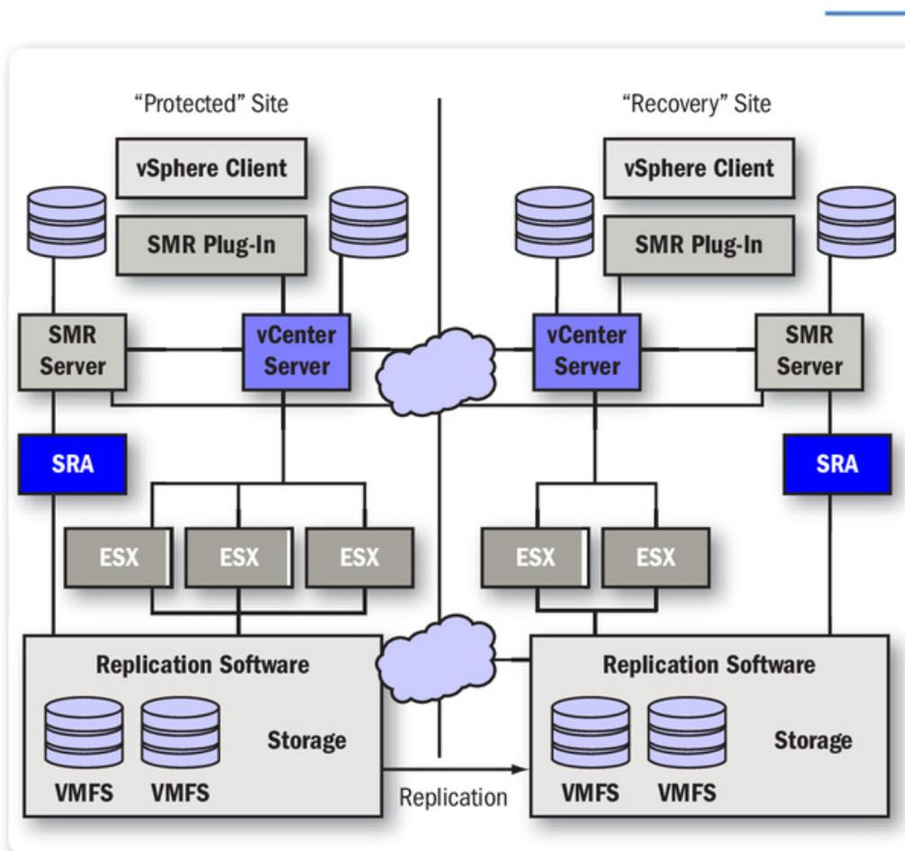
► **Figura 14.** SRM requiere de algún tipo de replicación de discos y dos infraestructuras virtuales, cada una con su vCenter.
