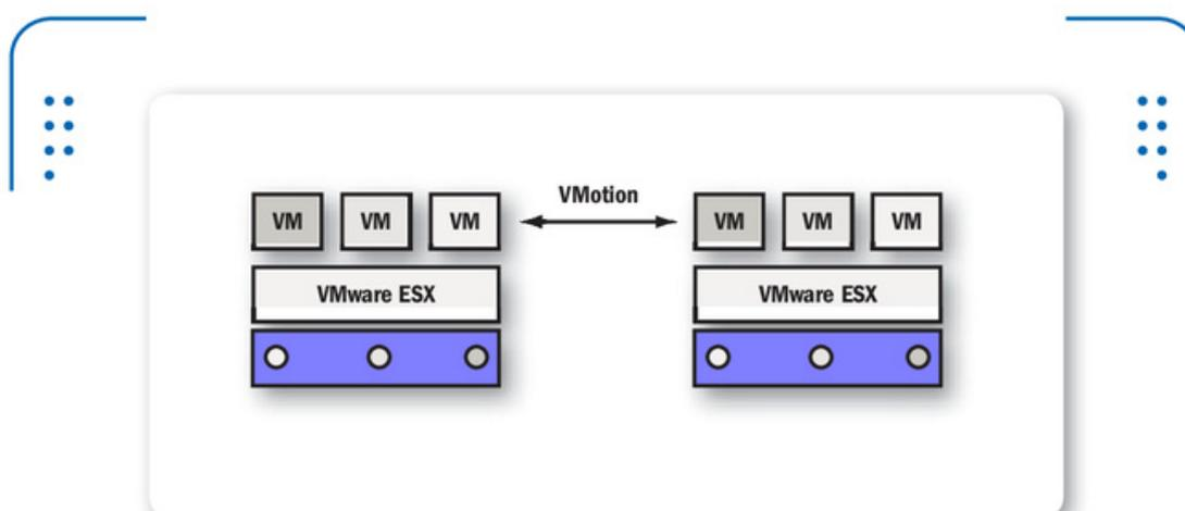
► **Figura 22.** Este diagrama esquematiza el concepto simplificado de la herramienta de vMotion.
