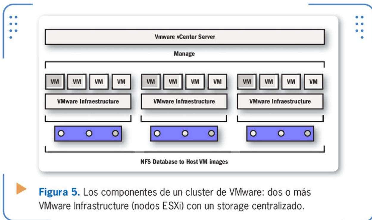
► **Figura 5.** Los componentes de un cluster de VMware: dos o más VMware Infraestructura (nodos ESXi) con un storage centralizado.
