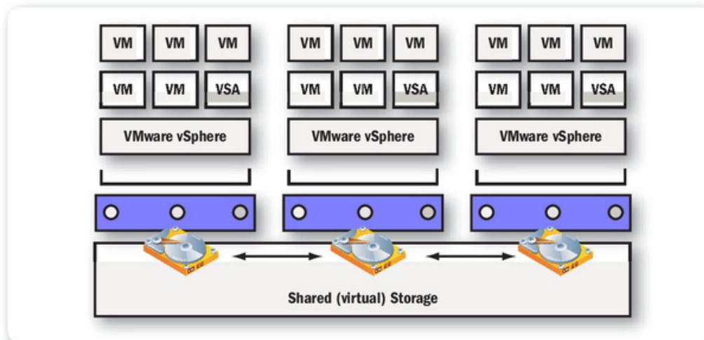
► **Figura 2.** El esquema general de funcionamiento de VSA muestra cómo los hosts comparten el almacenamiento interno.
