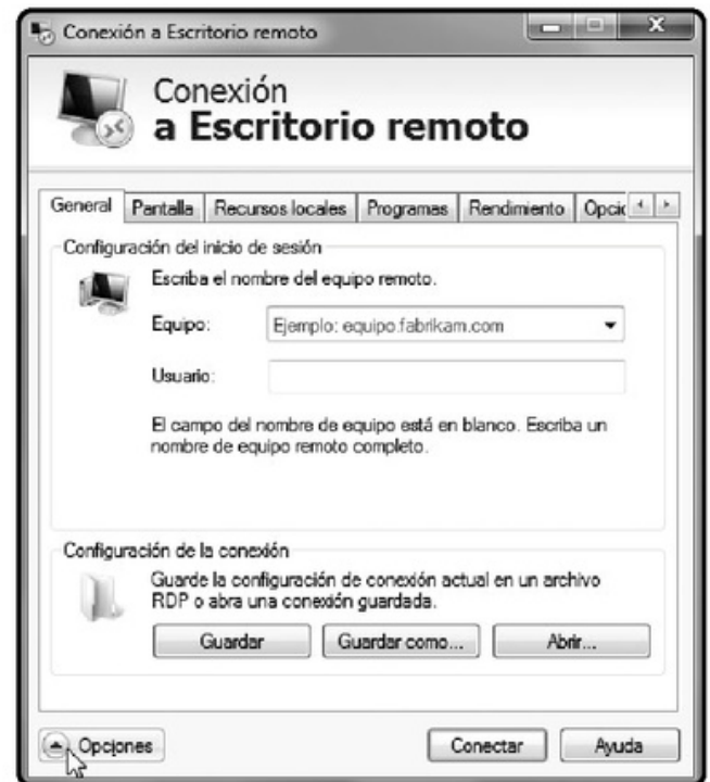
FIGURA 18. Si hacemos clic en Opciones , veremos algunas pestañas que nos presentan diversas alternativas de configuración para realizar una conexión de escritorio remoto.
