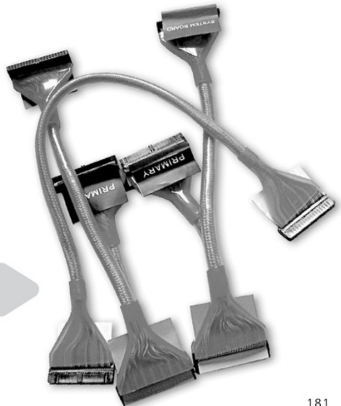
FIGURA 4. Cables IDE y Floppy redondeados de fábrica. Son bastante costosos pero no obstaculizan la circulación del aire de la PC.
