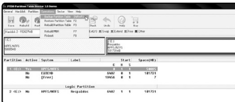
FIGURA 7. Podemos realizar una copia de respaldo del estado actual de las particiones: hacemos clic en Operations/Backup Partition Table y luego indicamos el destino.
