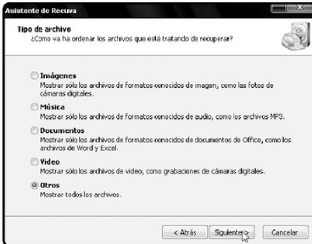
FIGURA 14. Marcamos la opción de archivo que deseamos recuperar. Si queremos recobrar todos los tipos de archivos, marcamos Otros. Presionamos Siguiente.
