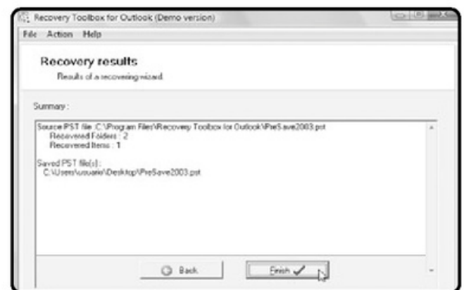
FIGURA 10. Una vez finalizado, veremos un informe de los resultados. Hacemos clic en el botón Finish para terminar.
