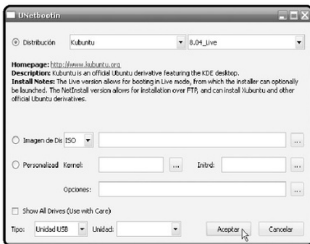
FIGURA 9. Una vez ejecutado UNetbootin, seleccionamos la ubicación de la imagen ISO correspondiente al tipo de instalación.
