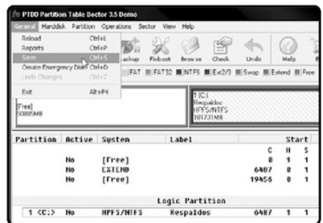
FIGURA 8. Para terminar, hacemos clic en menú General/Save para guardar los cambios efectuados en la tabla de particiones del disco.
