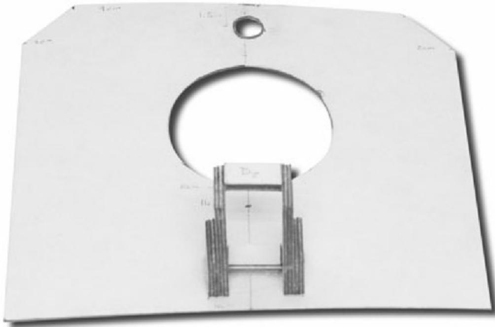
**Figura 24.** El orificio debe quedar centrado en la marca que hicimos antes para permitir que pase el eje del servo.
