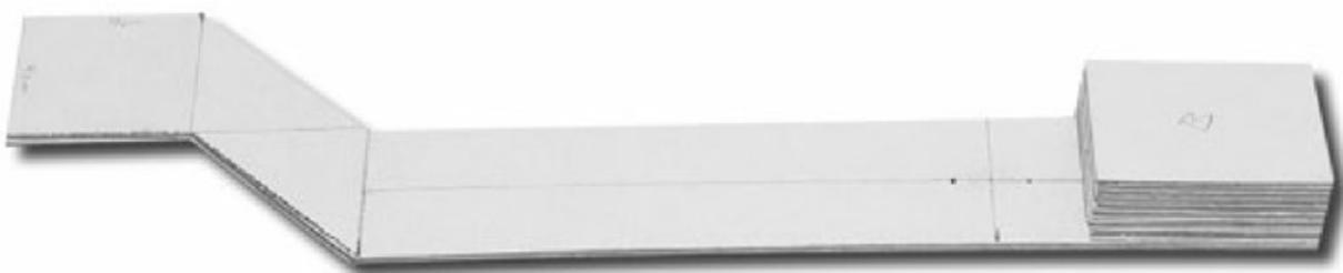
**Figura 13.** El contrapeso es colocado sobre el brazo. Podemos observar que no tapa el lugar por donde pasa el eje del servo.
