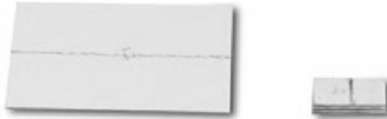
**Figura 24.** Trazamos líneas centradas en los componentes **I** y **J** que nos servirán de guía durante el montaje.
