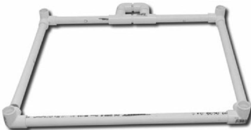
**Figura 15.** Aquí podemos observar el soporte de los componentes en etapa de ensamblar los tubos **B** para formar el marco.
