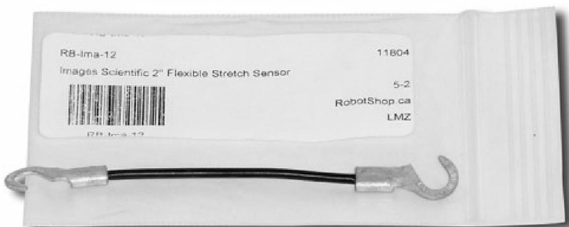
**Figura 44.** Éste es el sensor que nosotros utilizaremos. Tiene como ventajas el ser barato y fácil de colocar en nuestro guante.
