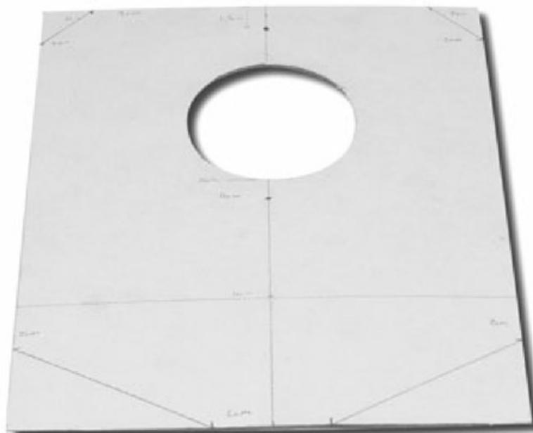
**Figura 4.** Trazamos líneas que unen las marcas realizadas en los bordes.
