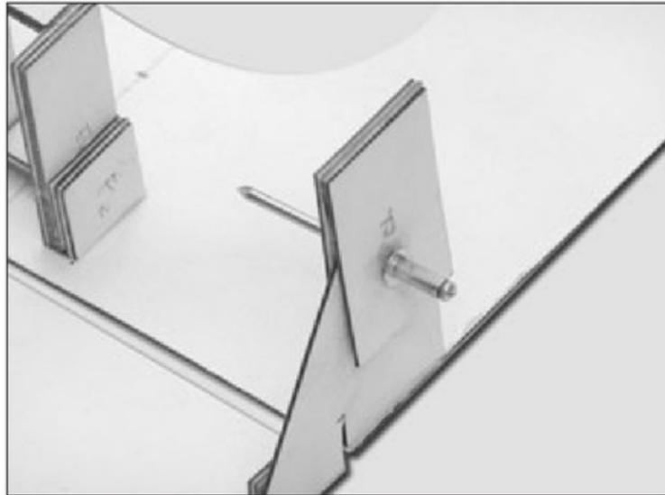
**Figura 58.** El soporte queda dentro del sostén, y el clavo actúa como eje para su movimiento.
