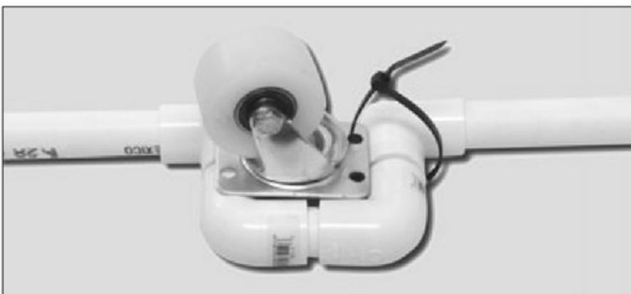
**Figura 20.** Los cinchos, o precintos, son colocados en los orificios de la base, en este punto, sin ajustarlos demasiado.
