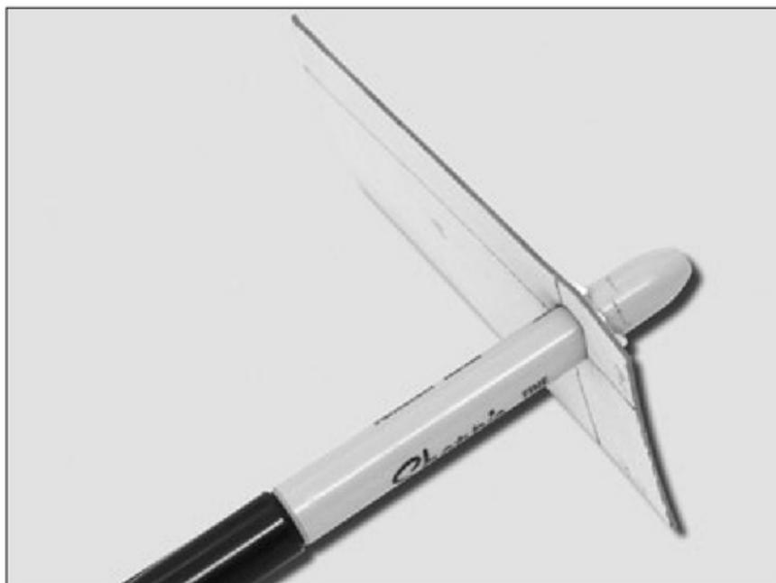
**Figura 6.** Un marcador que tenga el grosor necesario puede permitirnos hacer el agujero con el componente **A**
