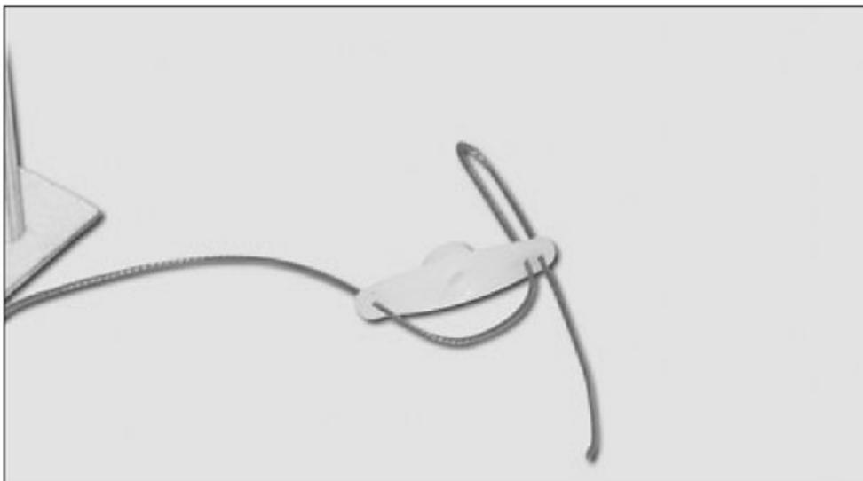
**Figura 39.** Ésta es la forma como debemos pasar el hilo por el elemento de actuación para empezar a fijarlo. En este momento, aún no tensamos el hilo.
