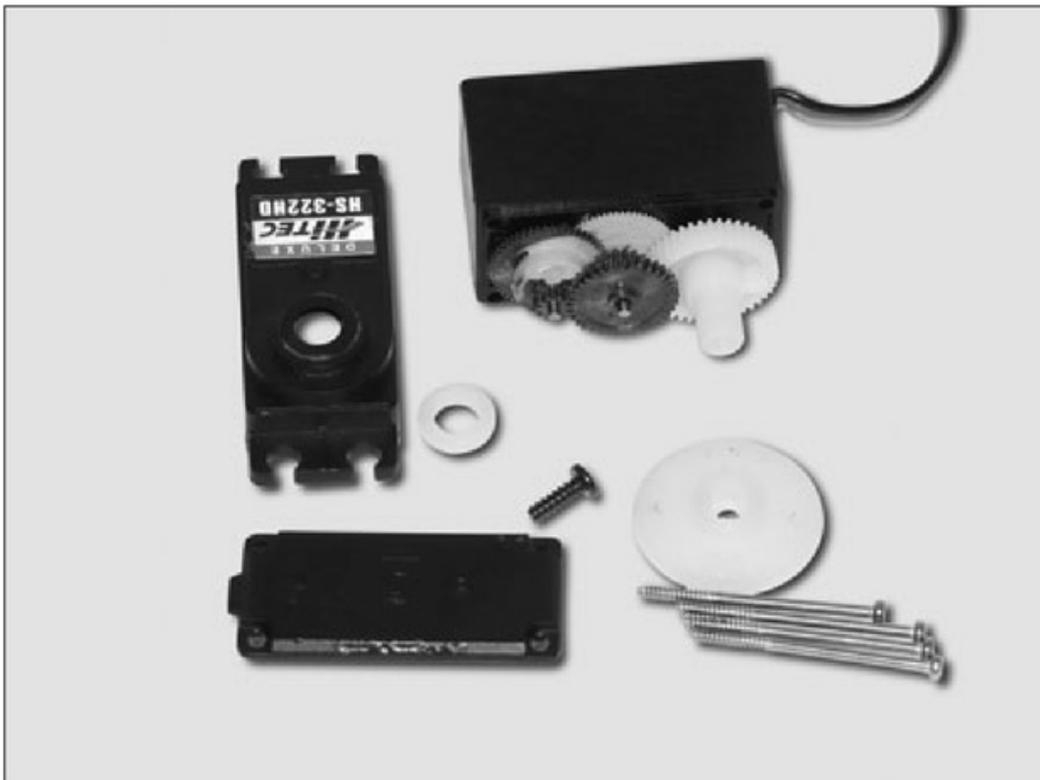
**Figura 13.** Esta figura nos muestra el motor, el sistema de engranes con el potenciómetro debajo y la caja del servo.
