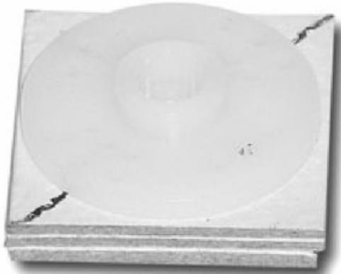
**Figura 31.** Nos ayudamos con el elemento de actuación del servo para poder marcar los lugares donde se colocarán los tornillos.
