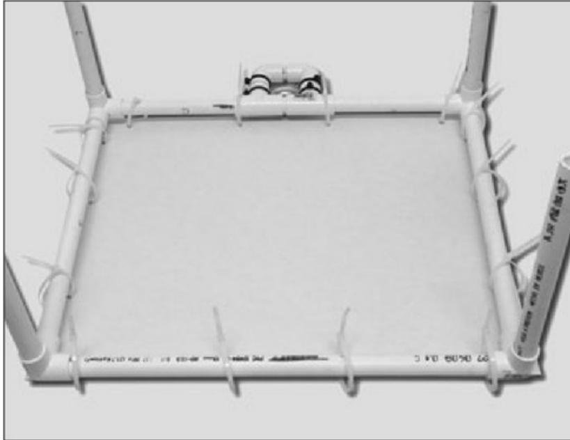
**Figura 28.** Hemos colocado los precintos alrededor del soporte del componente, y el piso se encuentra en posición para ser fijado en forma definitiva.
