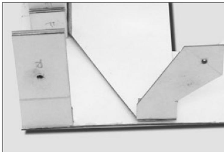
**Figura 57.** Tanto el soporte de la mandíbula como el sostén han sido perforados. Ambas perforaciones se encuentran a la misma altura.
