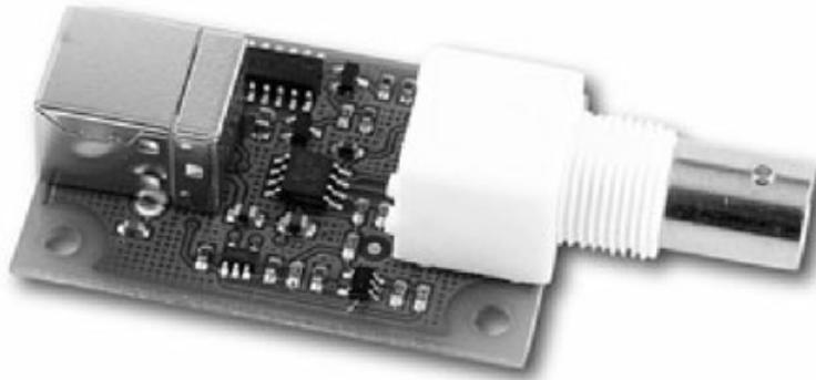
**Figura 15.** También podemos utilizar para nuestros proyectos sensores que pueden medir el pH de una sustancia, como el que se muestra en la fotografía.
