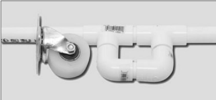
**Figura 19.** Éstos son los componentes necesarios para instalar la rueda de patín en nuestra plataforma.
