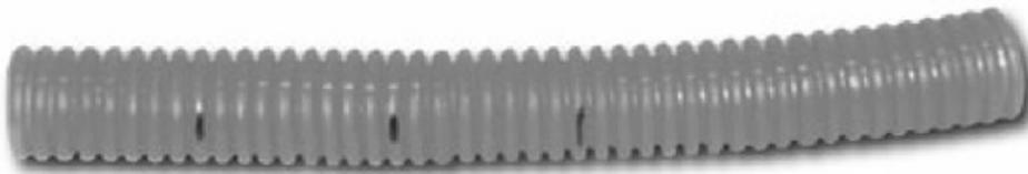
**Figura 23.** Los puntos en donde se crearán las articulaciones han sido marcados. Hay una separación de 2,5 cm entre ellos.
