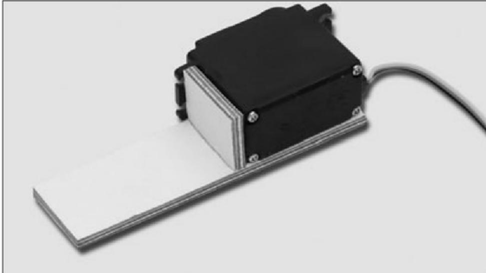
**Figura 25.** El componente **H** se pega sobre el componente **G**. Más adelante, nos servirá como asiento para el servo.
