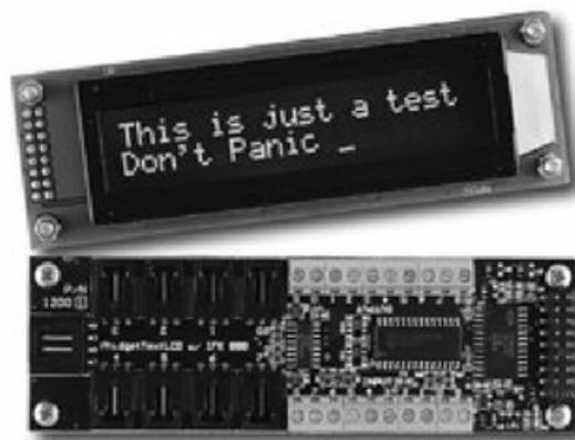
**Figura 11.** Esta versión de Phidget combina un 8/8/8 con una pantalla para poder mostrar mensajes o información.
