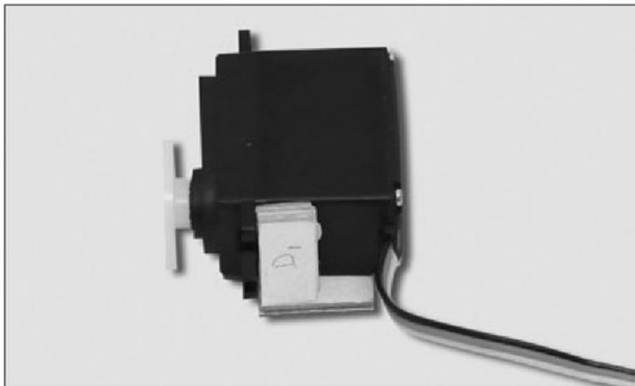
**Figura 18.** El componente **D** sostendrá al servo por medio de uno de sus estribos. Aquí lo vemos ubicado en posición.
