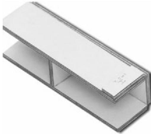
**Figura 29.** El componente *I* nos ayuda a incrementar el área de contacto del soporte.
