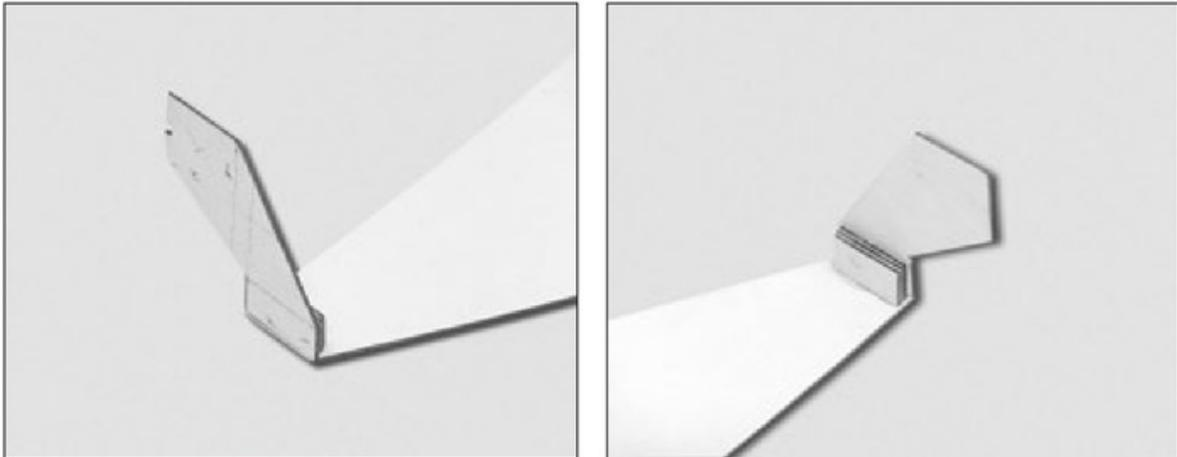
**Figura 47.** En ambas fotografías, podemos observar la forma en la que debemos pegar el soporte con las perforaciones de los tornillos sobre la mandíbula.
