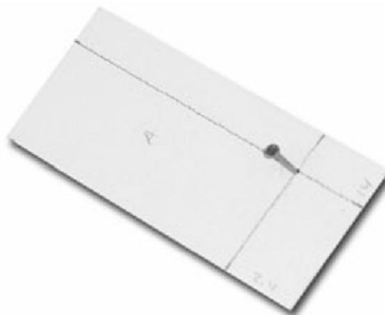
**Figura 4.** Con un clavo, hacemos una perforación inicial en el punto de intersección de las líneas.
