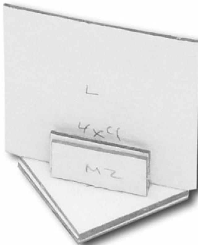
**Figura 36.** El soporte para el sonar se encuentra finalizado; todos los componentes han sido pegados con firmeza.
