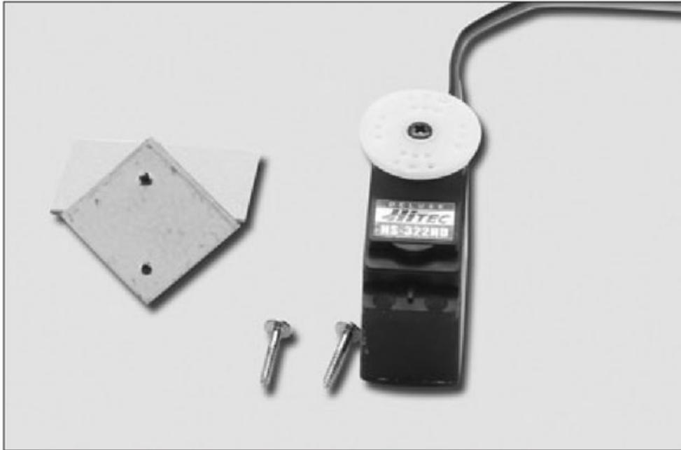
**Figura 51.** Necesitamos del sostén, del servo y los tornillos para finalizar el montaje del sonar.
