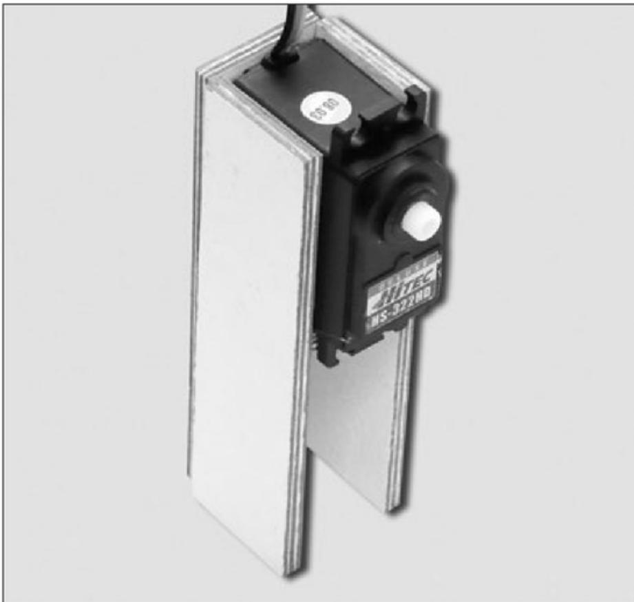
**Figura 28.** El servo queda ajustado sobre el soporte. Los cables no aparecen obstruidos.
