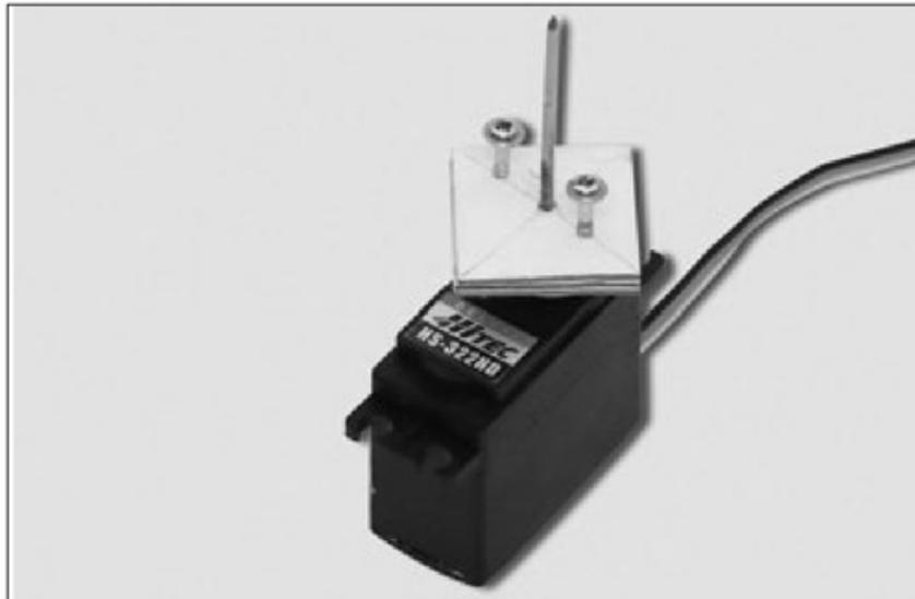
**Figura 15.** El sistema que sostendrá al ojo ha sido montado sobre el servo.
