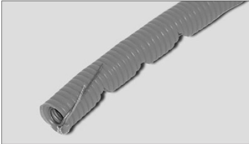
**Figura 36.** En el otro extremo del dedo robótico, también, doblamos el resorte para ajustarlo al tubo.
