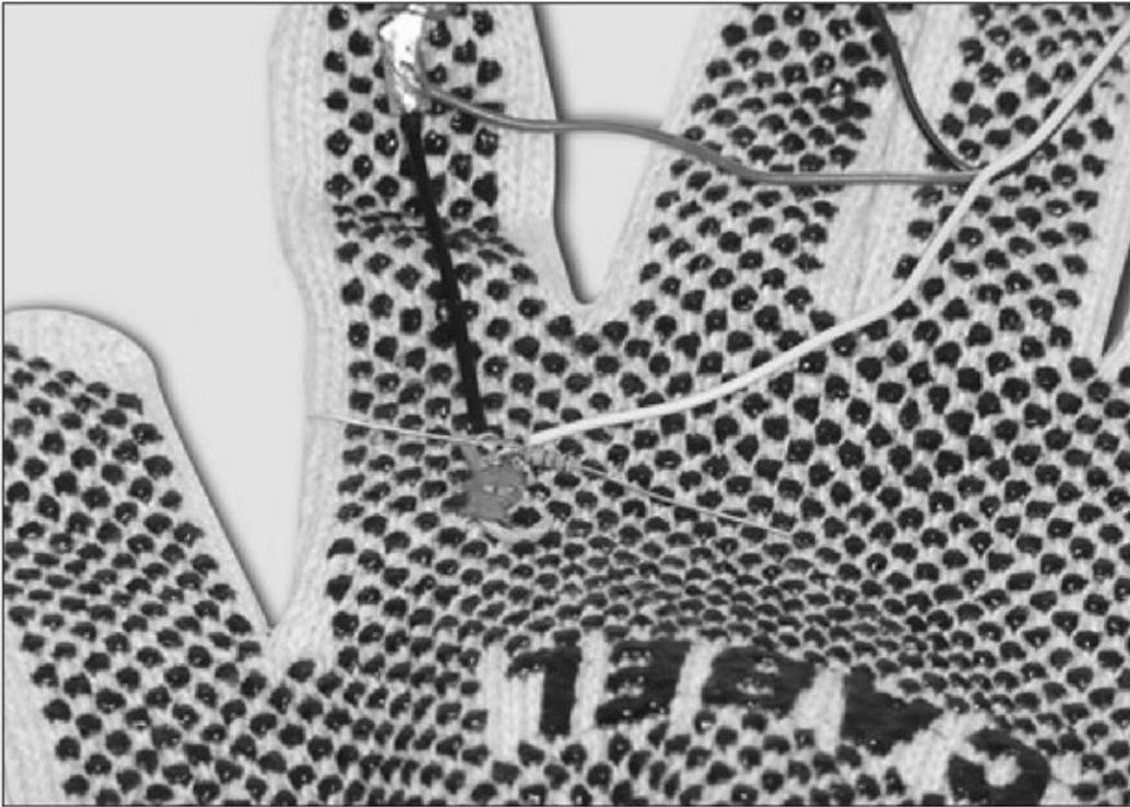
**Figura 51.** La resistencia y el hilo blanco quedan soldados a la otra terminal del sensor.
