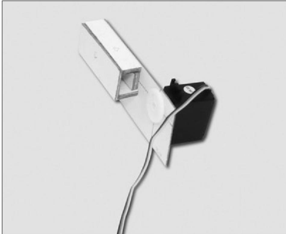
**Figura 13.** Esta figura nos muestra la forma en que debemos montar el servo pasando su eje por el agujero.
