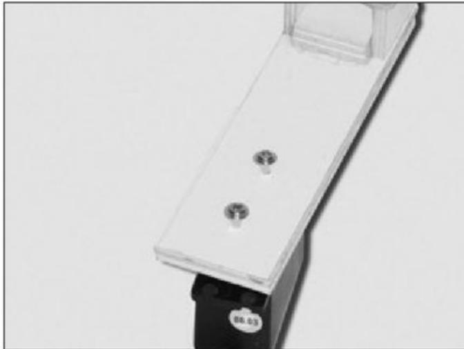
**Figura 19.** Con los tornillos, sujetamos el brazo del robot al servo.
