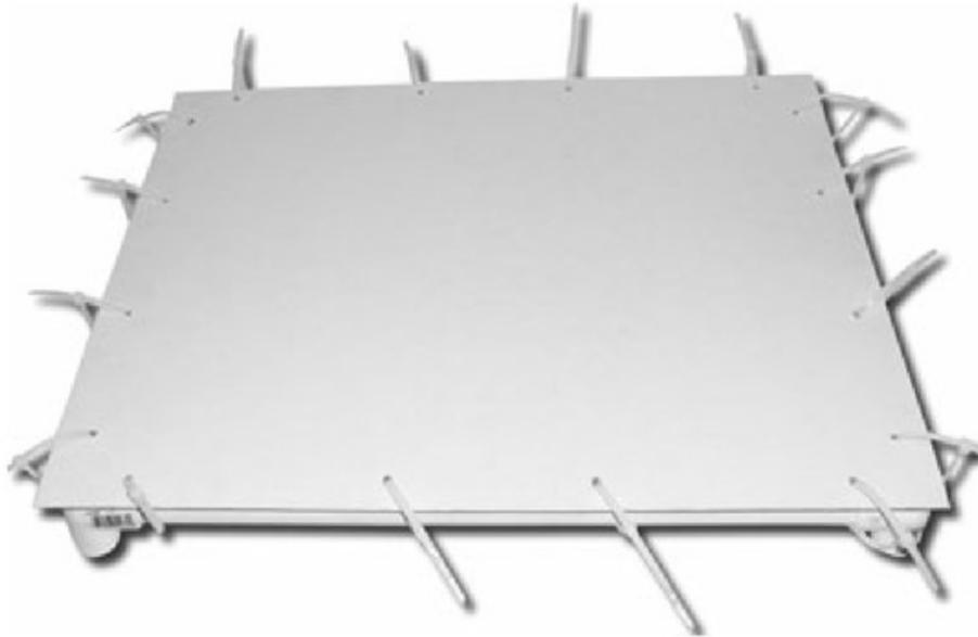
**Figura 26.** Ubicamos los precintos alrededor del piso, y los aprovechamos para sujetarlo al soporte de PVC.
