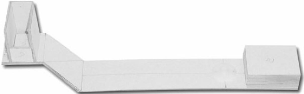
**Figura 43.** Ubicamos el elemento de actuación para luego poder marcar el lugar de los tornillos.
