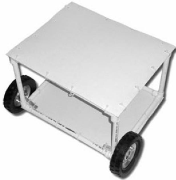
**Figura 32.** Instalamos el soporte de la computadora como un techo de la plataforma.
