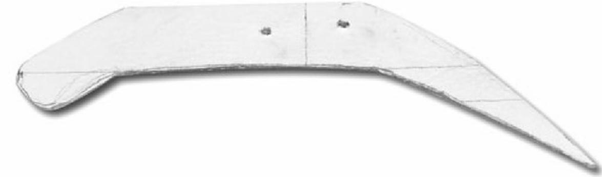
**Figura 29.** Aquí podemos observar las perforaciones que nos servirán de guía para los tornillos.
