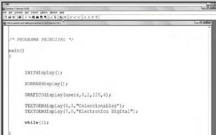
Abra el archivo **demoLCD.c**, compílelo y ejecútelo presionando el icono de reproducción o la tecla **F5**. Si quiere ejecutar el programa paso a paso, puede detenerlo con el icono correspondiente y avanzar mediante las teclas **F7** y **F8**, como en la mayoría de los entornos de desarrollo.
