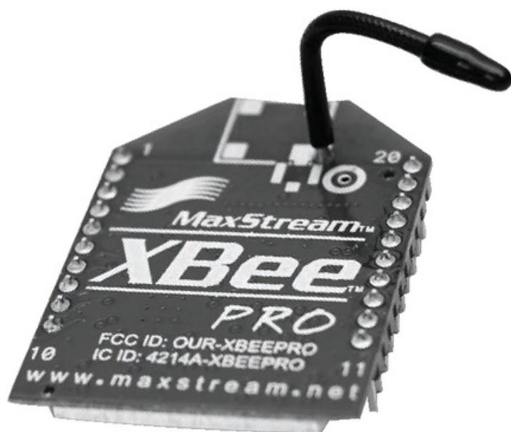
FIGURA 6. Módulo XBee-PRO con antena externa. Es más potente y cuenta con un receptor más sensible, con lo que logra distancias superiores.
