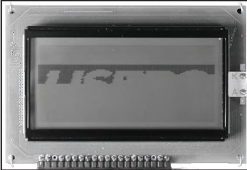
Elimine el breakpoint y coloque otro en la función `GRAFIC0display()`. Ejecute el código y, cuando tenga el cursor de color verde, ejecute paso a paso sin entrar en las demás funciones, con la tecla **F8**. Observe cómo los datos van siendo enviados al display uno a uno.
