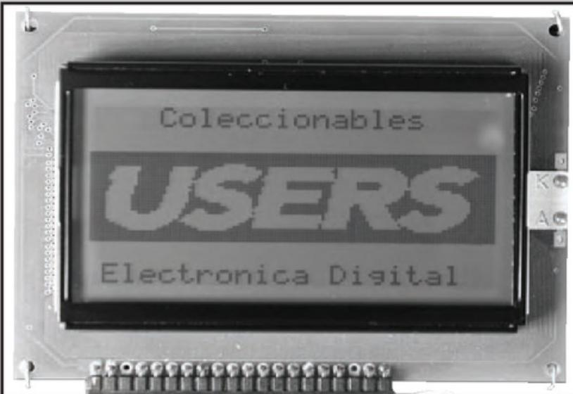
Terminado el proceso, vea el logo completo. Luego, puede eliminar el breakpoint y poner uno en el bloque `for()`, que realiza el dibujo de un carácter en la función `TEXT0ENDisplay()`. Ejecute paso a paso mediante la tecla **F7** y observe cómo se dibuja el carácter en el display.
