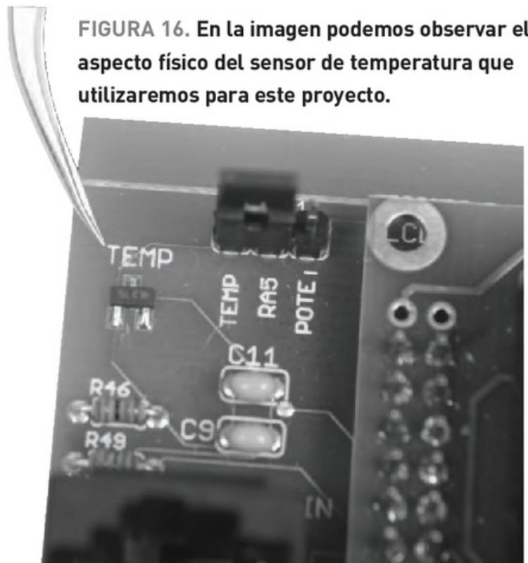
de la ecuación de la recta que se muestra en la **Figura 17: Temperatura (°C) = (Vout (Volts) – 500 mV) / 10 mV/°C**; donde **Vout** es la tensión de salida que mediremos con el conversor, y **10 mV/°C**, la pendiente de la recta (**Figura 17**).
