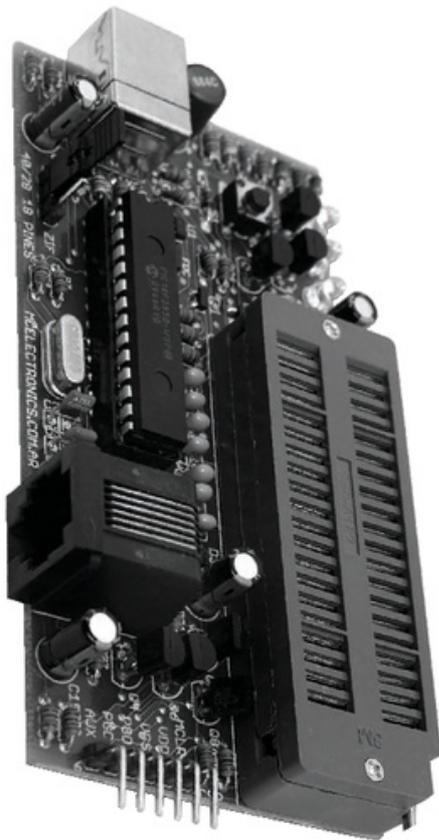
**FIGURA 14.** En esta imagen del programador MCE PDX USB podemos ver el conector de programación ICSP (la tira de postes) que pueden actuar como los canales de entrada del Analizador Lógico.
