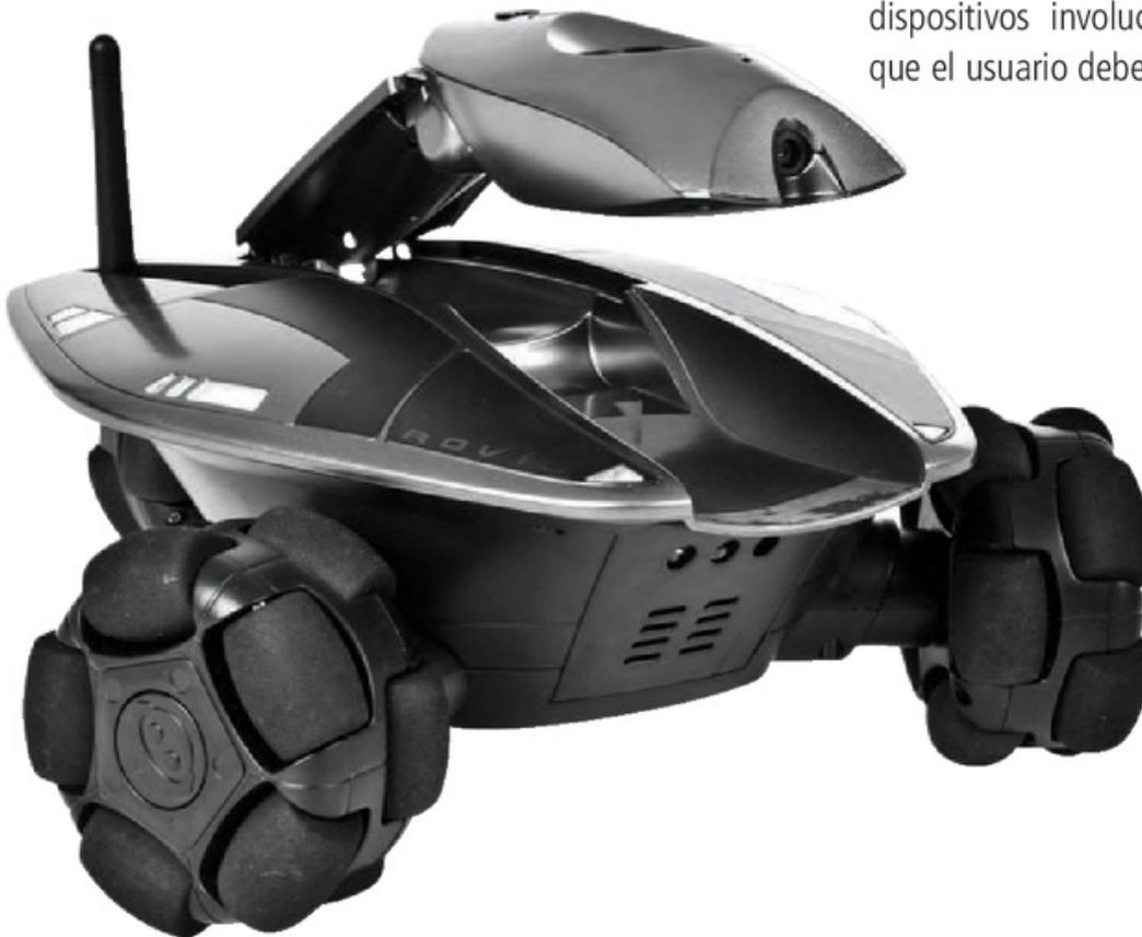
**FIGURA 2. Podemos observar un robot que incorpora la tecnología Wi-Fi 802.11b/g. También se pueden ver estos dispositivos con Bluetooth o GSM.**
