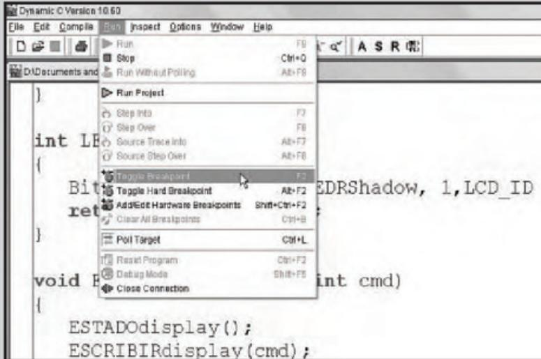
Posicione el cursor y ponga un breakpoint en la función **ESCRIBIRdisplay()**, mediante la opción **Run:Toggle Breakpoint** o al pulsar la tecla **F2**; verá un rectángulo rojo. Cuando la ejecución se detiene en dicha función, observará un rectángulo verde.
