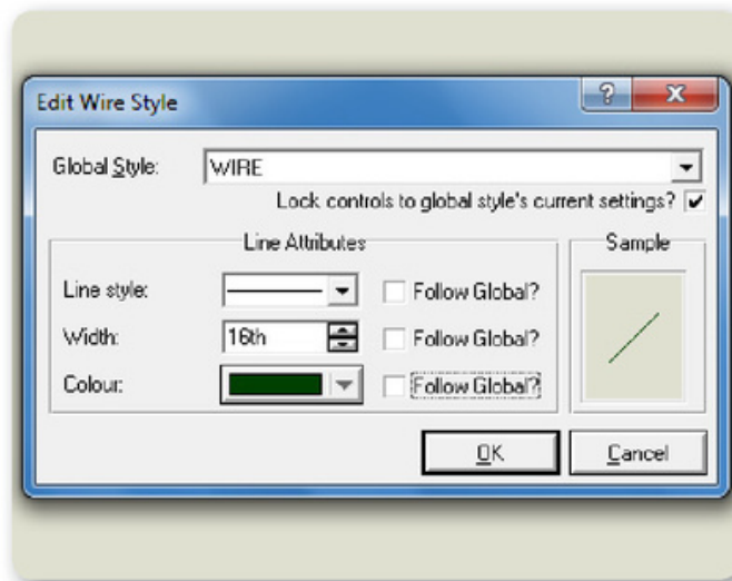
► Figura 8. La apariencia de las líneas de conexión se puede personalizar de forma local.
