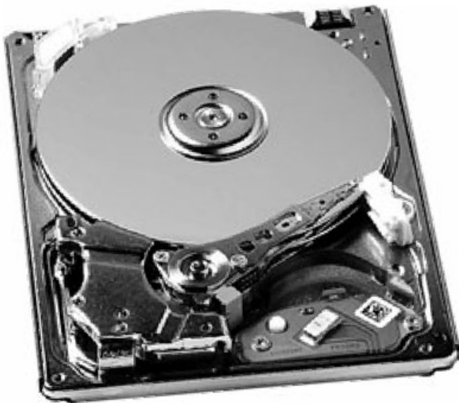
FIGURA 1. El disco rígido permite guardar grandes cantidades de información utilizando principios magnéticos.
