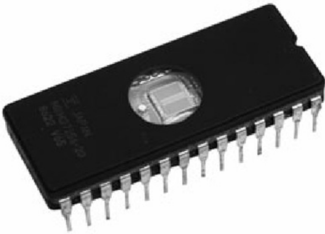
FIGURA 2. Memoria MBM27256-20 de tipo EPROM nMOS de 32 k x 8 bits construida por la empresa Fujitsu. La ventana que posee permite borrar su contenido mediante luz UV.
