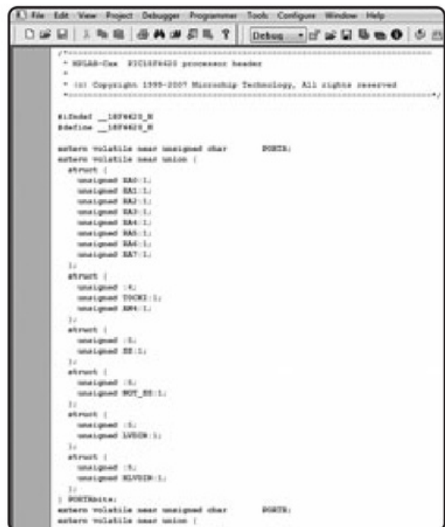
FIGURA 13. Vemos cómo el compilador utiliza las uniones y las estructuras para definir los registros especiales (SFR) del PIC. En este extracto del archivo p18f4620.h vemos de qué modo se definen los bits del PORTA.
