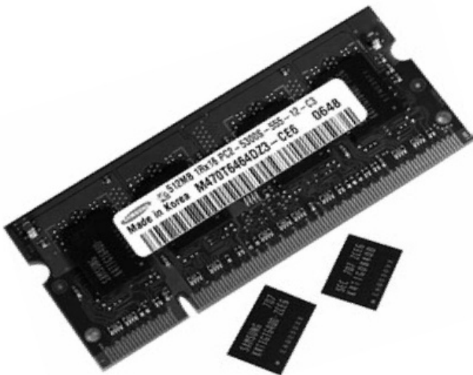
FIGURA 14. La desventaja es que necesitan de un circuito exterior para realizar el refresco.
