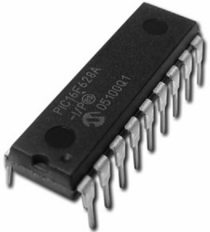
FIGURA 1. Los microcontroladores PIC son uno de los dispositivos más utilizados en el área de control. Aquí podemos ver uno de los encapsulados que ofrece el fabricante.
