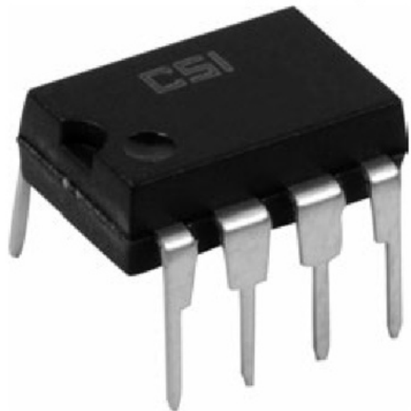
FIGURA 6. Las memorias EEPROM FLASH son una variante de la memoria EEPROM que permite escribir o borrar múltiples posiciones de memoria simultáneamente.
