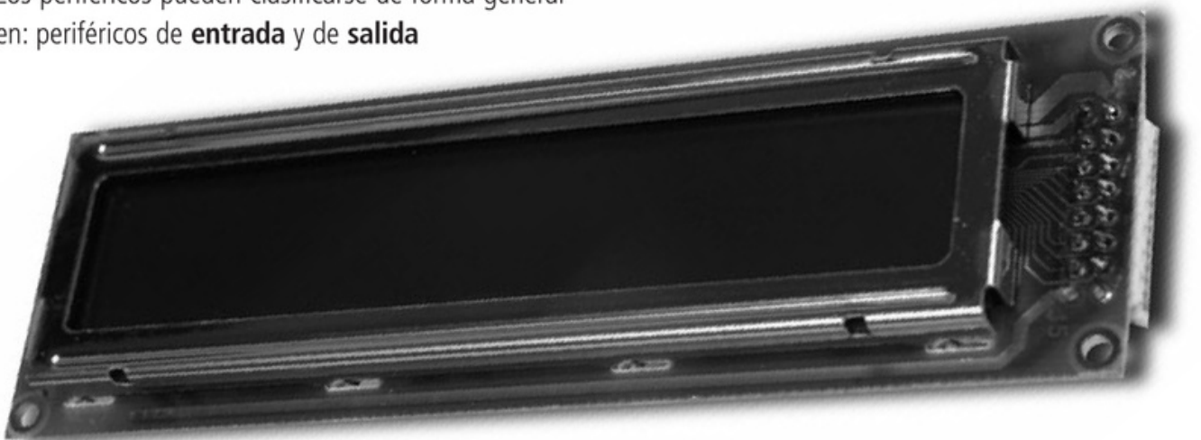
FIGURA 7. Las pantallas LCD son muy utilizadas como periféricos de salida para mostrar los resultados de las operaciones del procesador.
