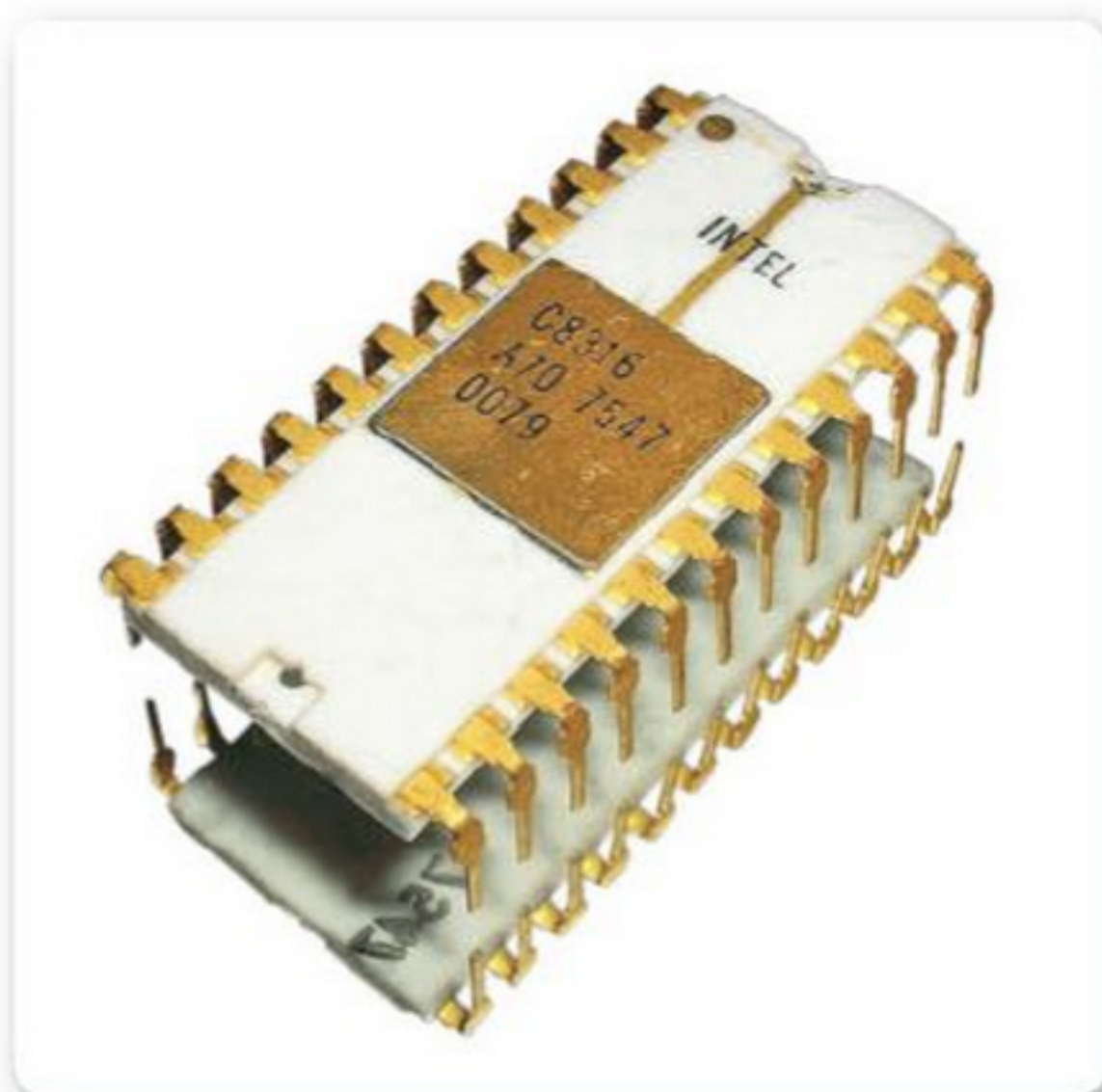
Figura 7. Circuito integrado Intel 8316 . Es una memoria ROM de 2 K x 8 con tecnología N-MOS.
