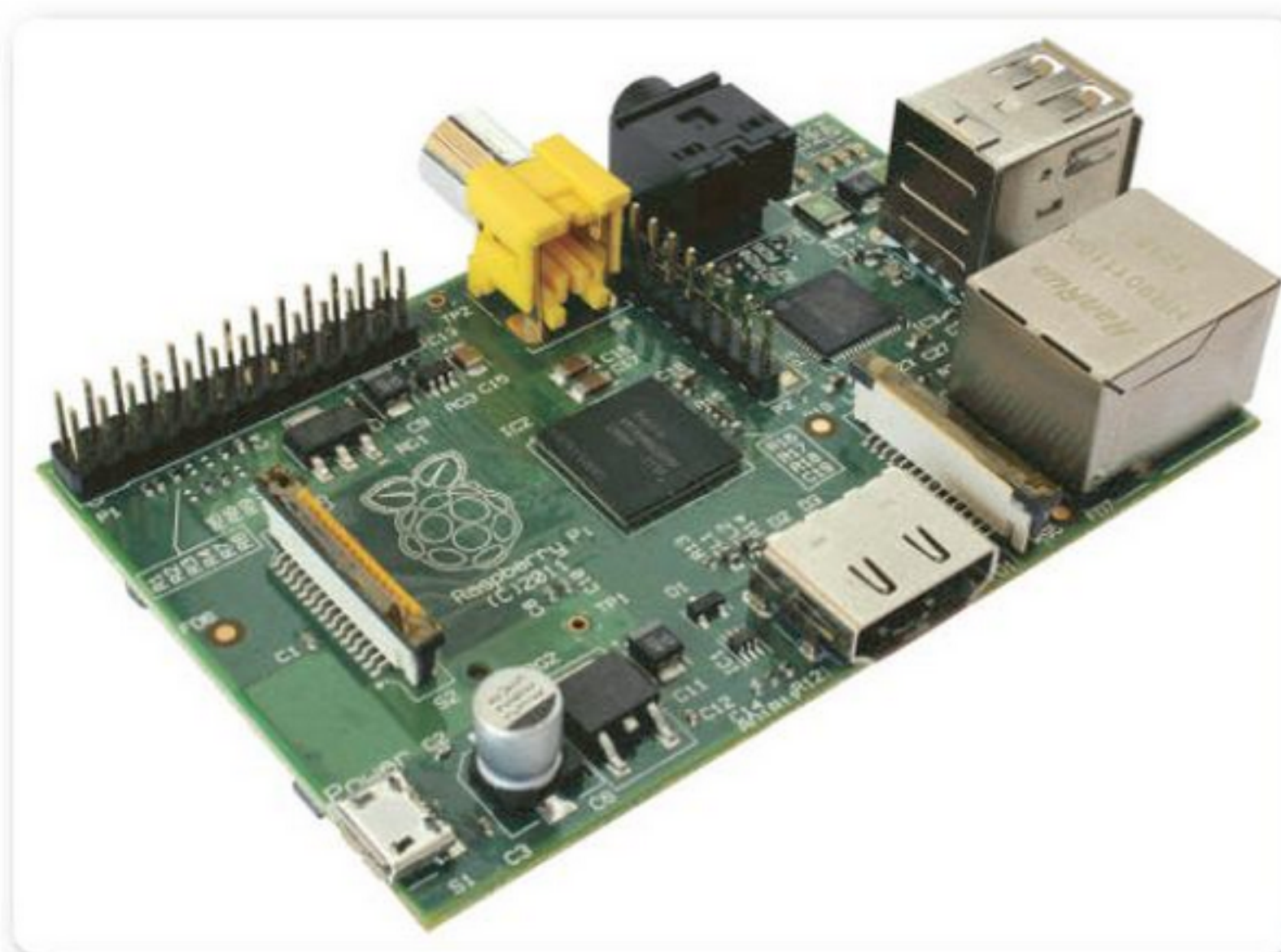
Figura 1. Computadora de placa reducida Raspberry Pi modelo B basada en un microprocesador ARM1176JZF-S de 32 bits a 700 MHz.
