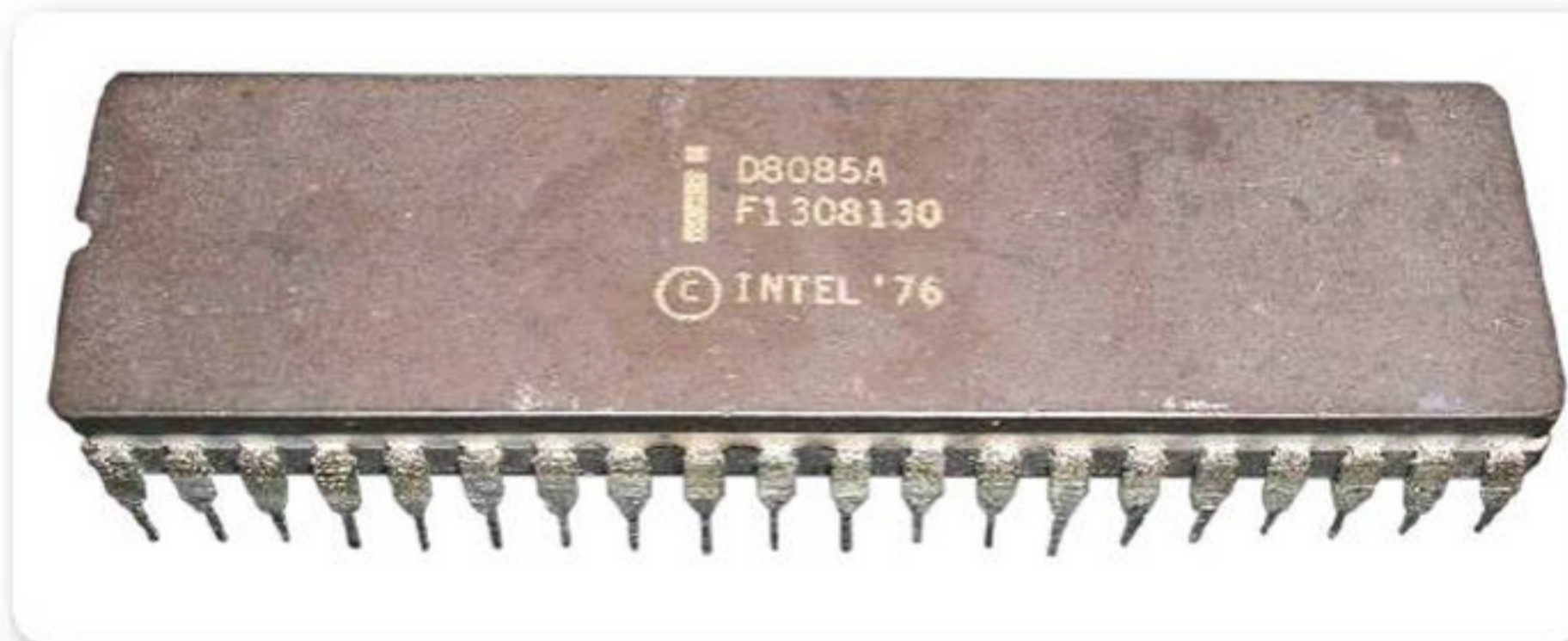
Figura 1. Microprocesador Intel 8085A introducido en el mercado en 1976. Utiliza tecnología N-MOS (MOS de canal N).
