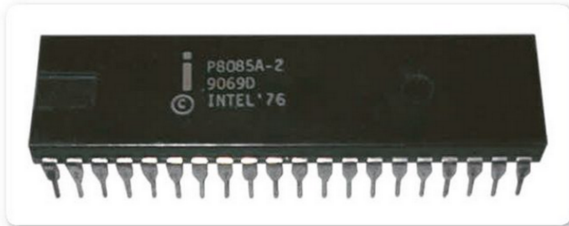
Figura 2. Microprocesador Intel 8085A-2 con reloj a 5 MHz, que mejora el rendimiento del sistema donde está implementado.
