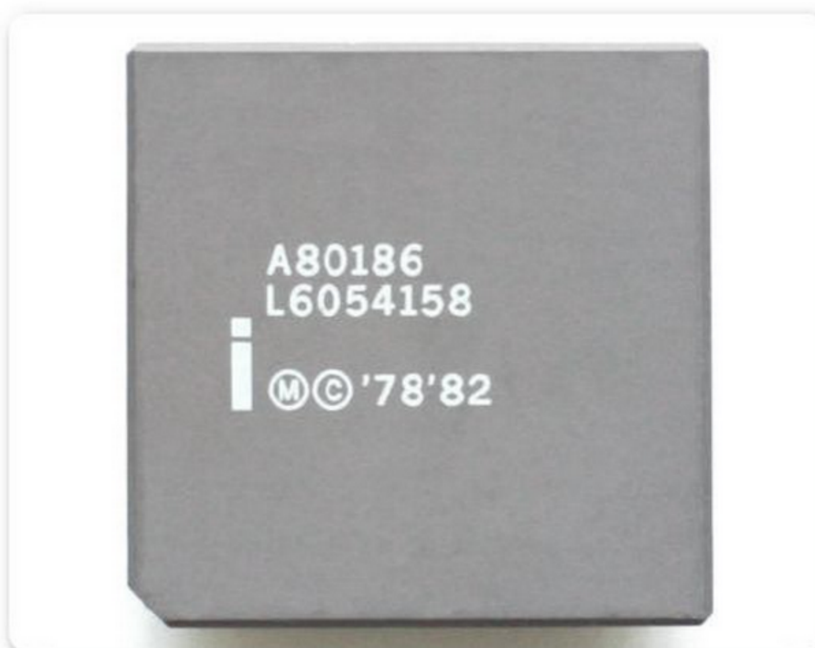
Figura 5. Los microprocesadores 80186 y 80188 fueron desarrollados por Intel alrededor de 1982 y son una mejora del Intel 8086/8088, respectivamente.
