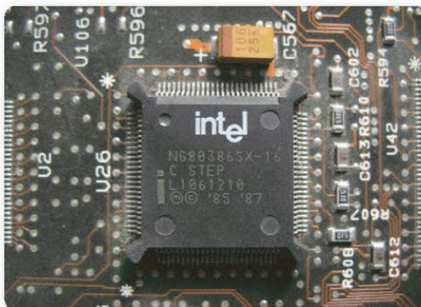
Figura 3. Microprocesador 80386 CISC con arquitectura x86 de 32 bits, fabricado y producido por la empresa Intel.
