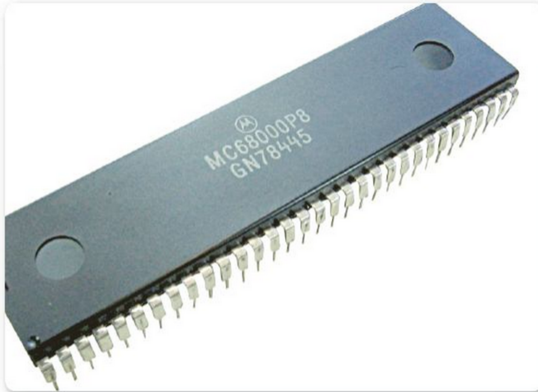
Figura 4. Microprocesador Motorola MC68000 de 16 bits, 64 pines y tecnología HMOS fabricado actualmente por Freescale.
