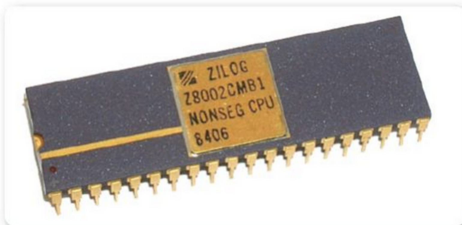
Figura 1. Microprocesador Zilog Z8000 de 16 bits. El Z80000 fue una continuación del diseño en 32 bits.
