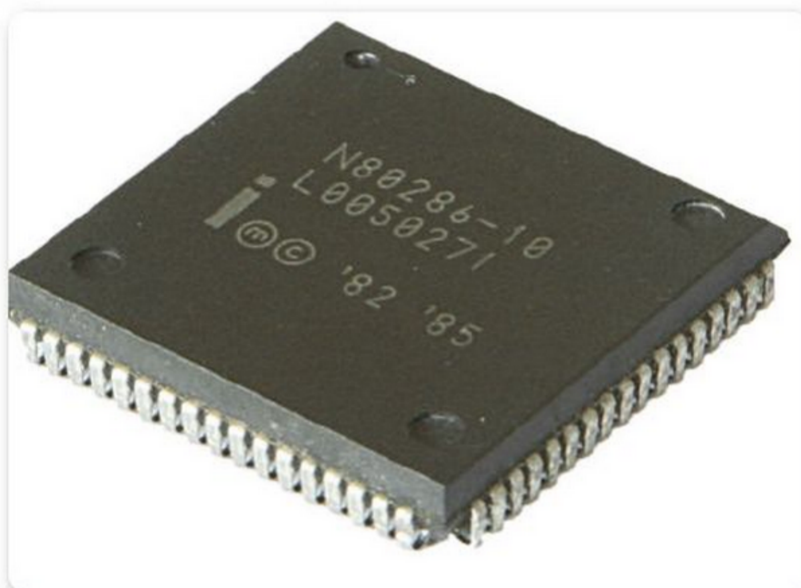
Figura 6. Microprocesador Intel 80286 de 16 bits. Pertenece a la familia x86 y cuenta con 134.000 transistores.
