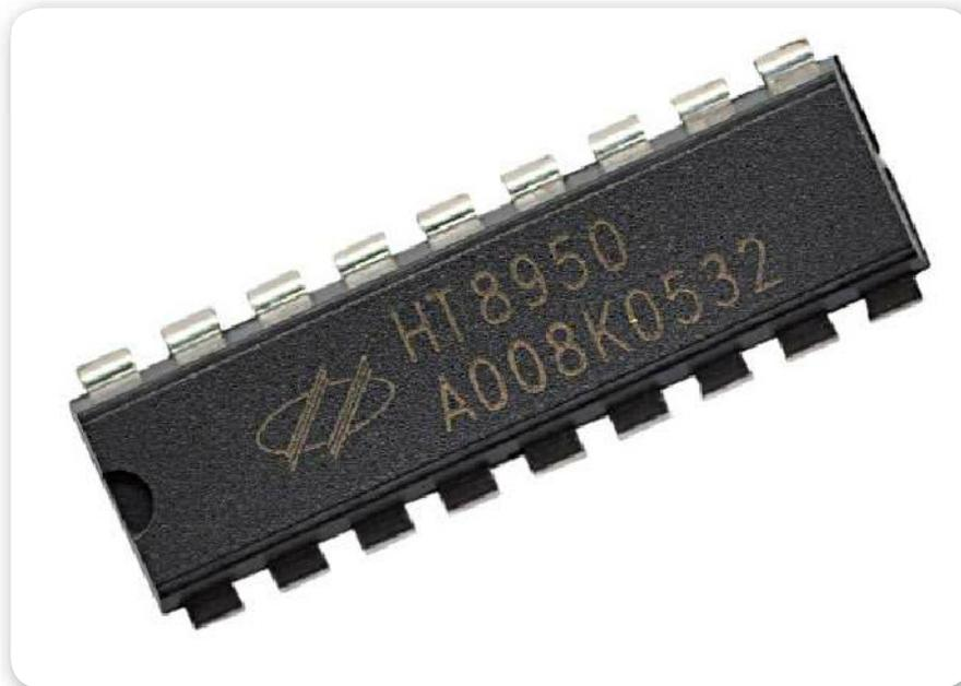
**Figura 17.** La numeración de los pines se realiza a partir del primero, a la izquierda de la muesca, en el extremo izquierdo del integrado.
