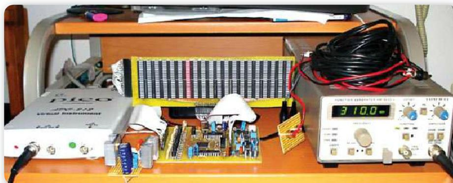
**Figura 6.** Recurriendo a circuitos integrados operacionales, procesadores de señal **DSP** y excitadores **NPN** y **Darlington**, construimos un sencillo y eficaz analizador de espectro.
