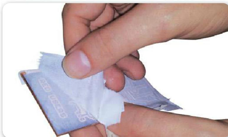
**Figura 27.** Después de planchar, se debe dejar reposando en agua y luego despegar suavemente el papel. Después, limpiar con agua.
