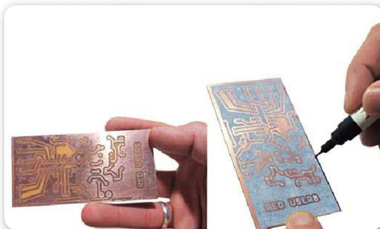
**Figura 28.** Si es necesario, se deberá rellenar con marcador indeleble donde no haya quedado bien adherido el tóner.
