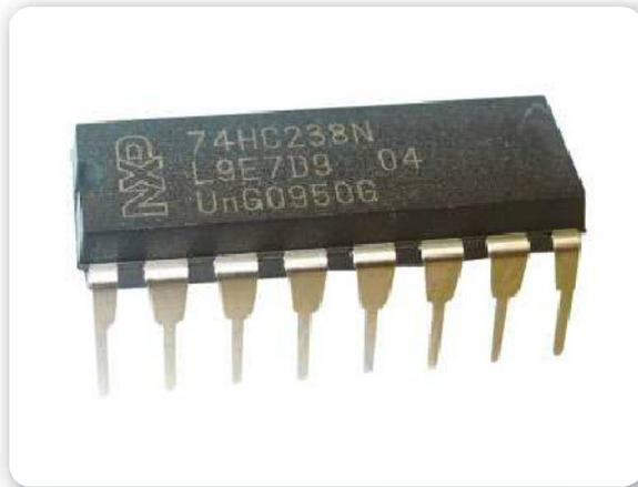
**Figura 23.** Decodificador de tres líneas (**HIGH-CMOS**) de rápida conmutación, muy utilizado en direccionamiento de memoria.
