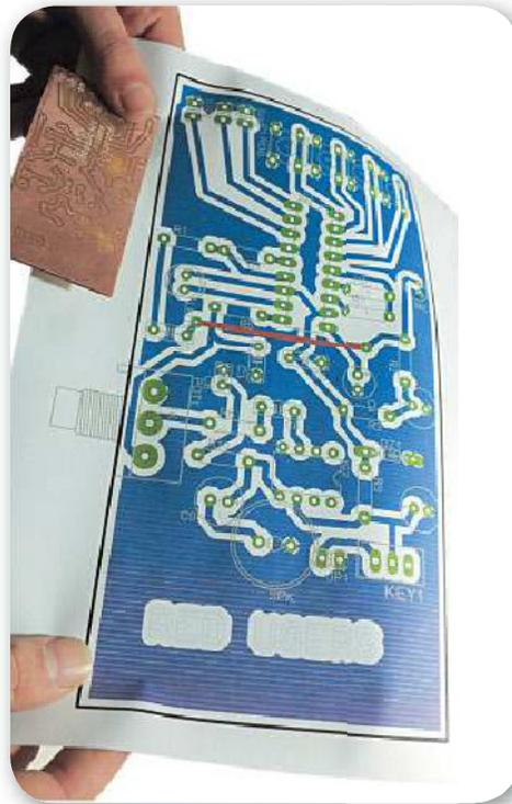
**Figura 29.** Para ubicar los componentes, se recomienda ayudarse con el PCB diseñado en **EAGLE**.
