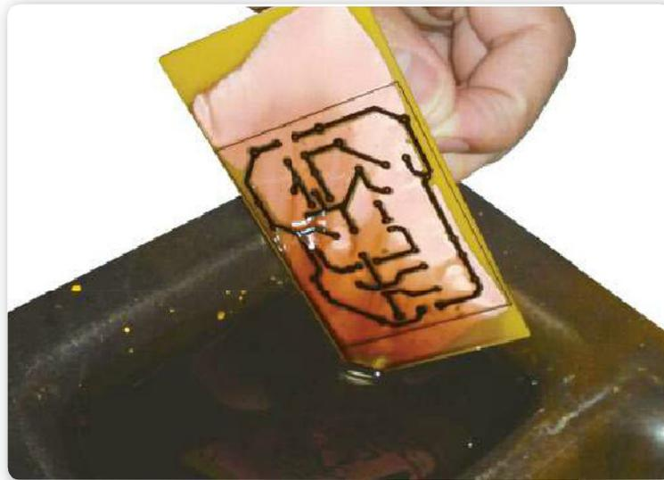
**Figura 11.** Una vez finalizada la etapa de planchado, se sumerge la placa en **percloruro férrico** para crear el circuito impreso.
