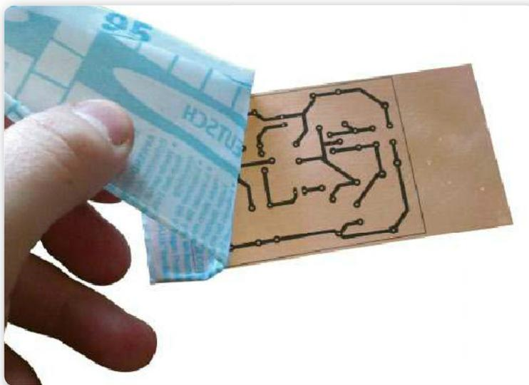
**Figura 10.** Una vez que la placa esté limpia, evitaremos tocar el cobre con las manos para no volver a engrasarla.
