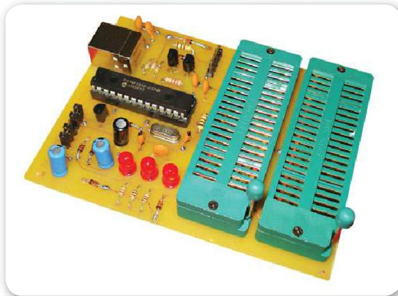
**Figura 22.** El programador **JDM** es sencillo y fácil de construir. Funciona con la mayoría de los PIC y también con algún AVR. Lo conectamos a la PC mediante puerto serie.
