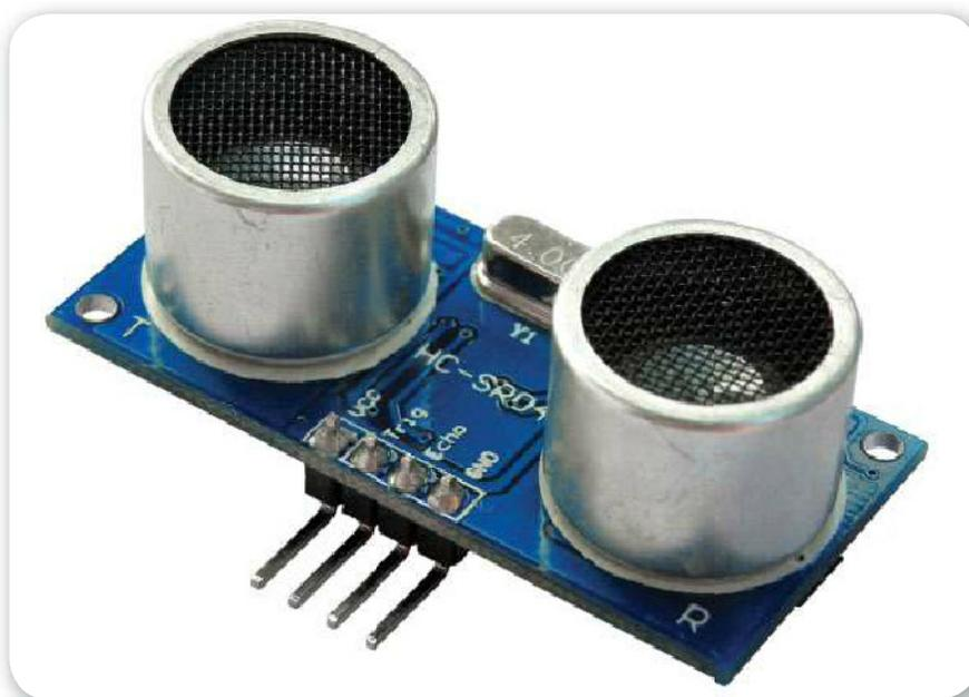
**Figura 18.** Sensor de distancia por ultrasonido que mide distancias de 2 cm a 3 m y requiere un pin I/O para conectarlo a un microcontrolador.
