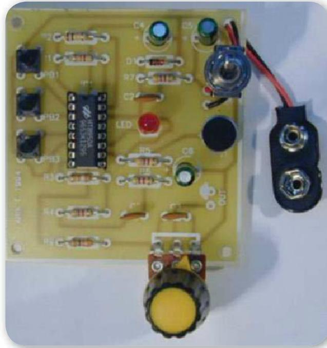
**Figura 32.** Variante del circuito con el **HT8950A**.
