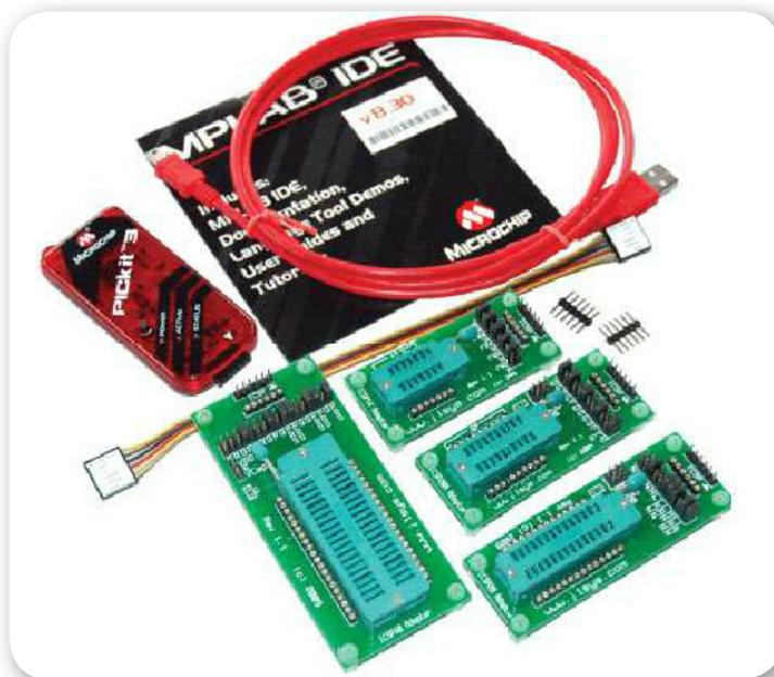
**Figura 21.** PICkit 2 y PICkit 3 son herramientas proporcionadas por Microchip para grabar el programa que se ejecutará en un microcontrolador PIC.
