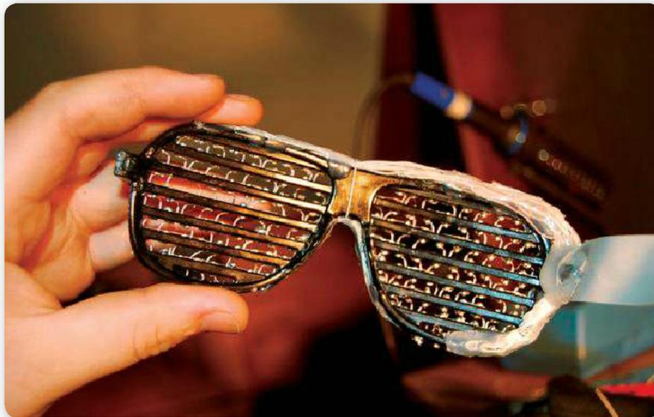
**Figura 4.** Un proyecto curioso y original es el de los lentes con LEDs integrados y un circuito de luces audiorrítmicas.
