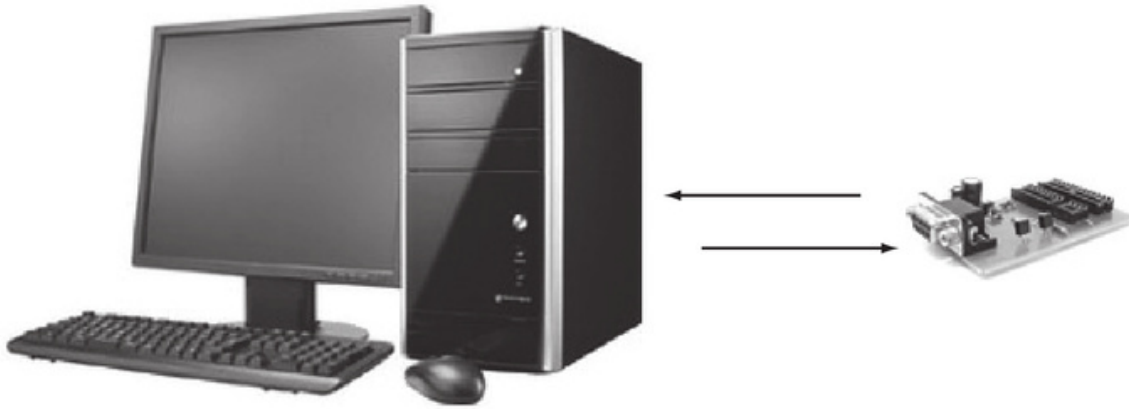
Figura 12. Mediante un grabador se puede leer o escribir en la memoria de programa del PIC.
