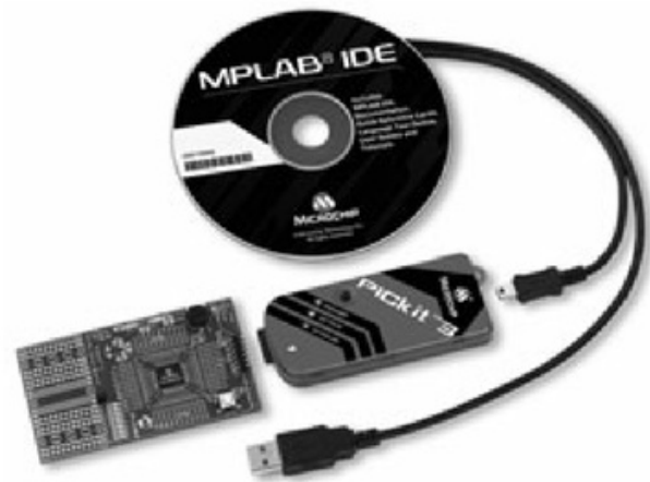
Figura 3. El PICkit 3 es fabricado por Microchip y es un grabador eficiente y muy confiable.
