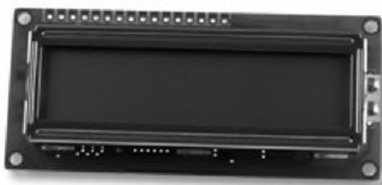
Figura 9. Apariencia física de un display de 2 líneas y 16 caracteres por línea.
