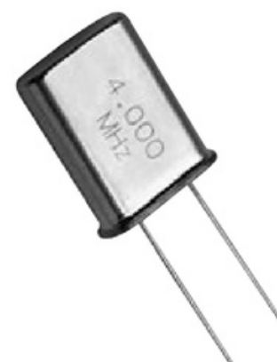
Figura 2. Lo típico para un PIC16F84A es un cristal de cuarzo de 4 MHz para generar la señal de reloj.
