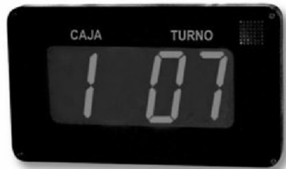
Figura 7. Con el PIC16F84A podemos construir un sencillo contador de turnos como los de los bancos o negocios.
