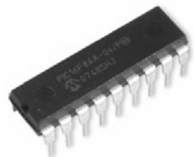
Figura 9. El PIC16F84A es un simple circuito integrado de 18 pines, pero encierra un dispositivo muy poderoso.
