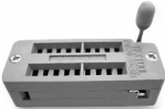
Figura 9. Una base de cero fuerza de inserción (ZIF) nos será de utilidad para colocar el PIC en el grabador.
