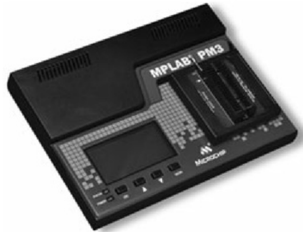
Figura 4. MPLAB PM3 es un grabador universal profesional que puede grabar prácticamente cualquier PIC.
